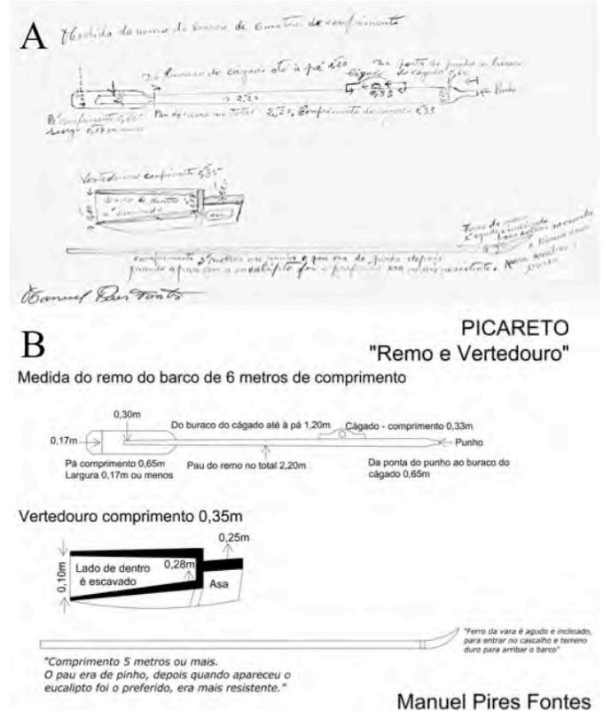
Figura 14. Remo, vertedouro e vara do barco para Profissionais. A: Desenho original do Calafate Manuel Fontes. B: Trabalho de revisão da Arq.<sup>a</sup> Elsa Severino.
